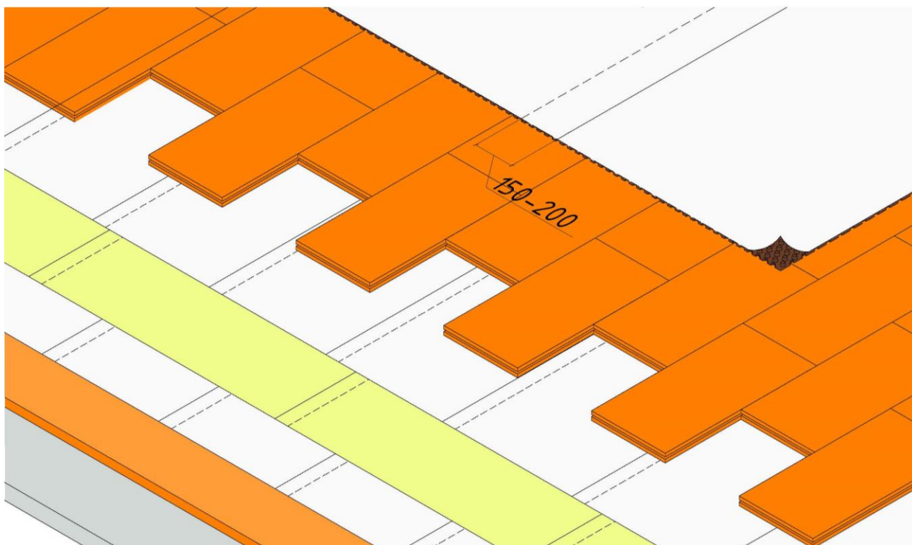
Рисунок 33. Раскладка профилированной мембраны
