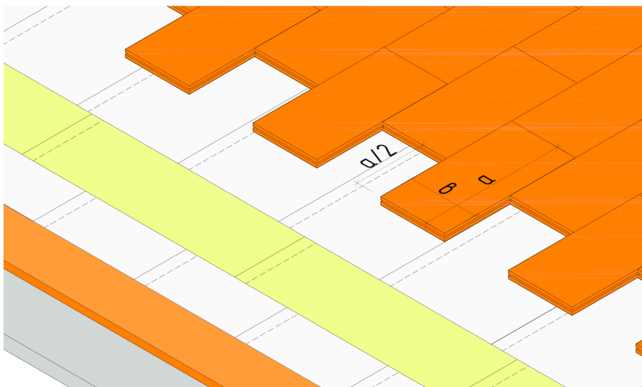
Рисунок 32. Раскладка плит теплоизоляции ПЕНОПЛЭКС
