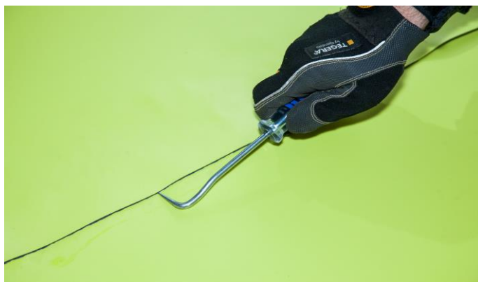
Рисунок 31. Проверка сварного соединения экстрактором шва
